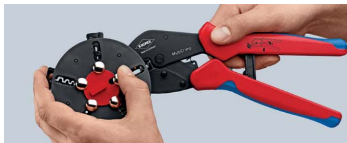
Výměna krimpovacího nástavce: Odaretujte polohu zásobníku, sejměte krimpovací nástavec z kleští
