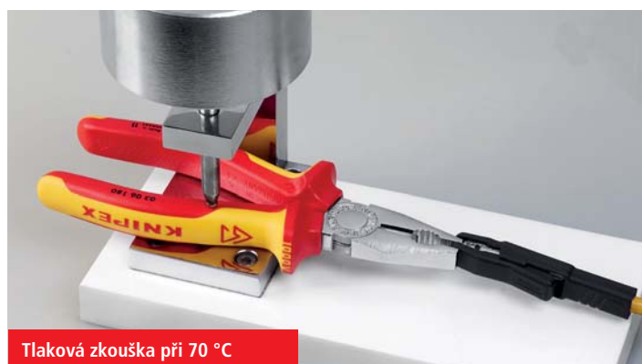
Testování přilnavosti izolace rukojeti asociací VDE se provádí při 500 N a 70°C.
